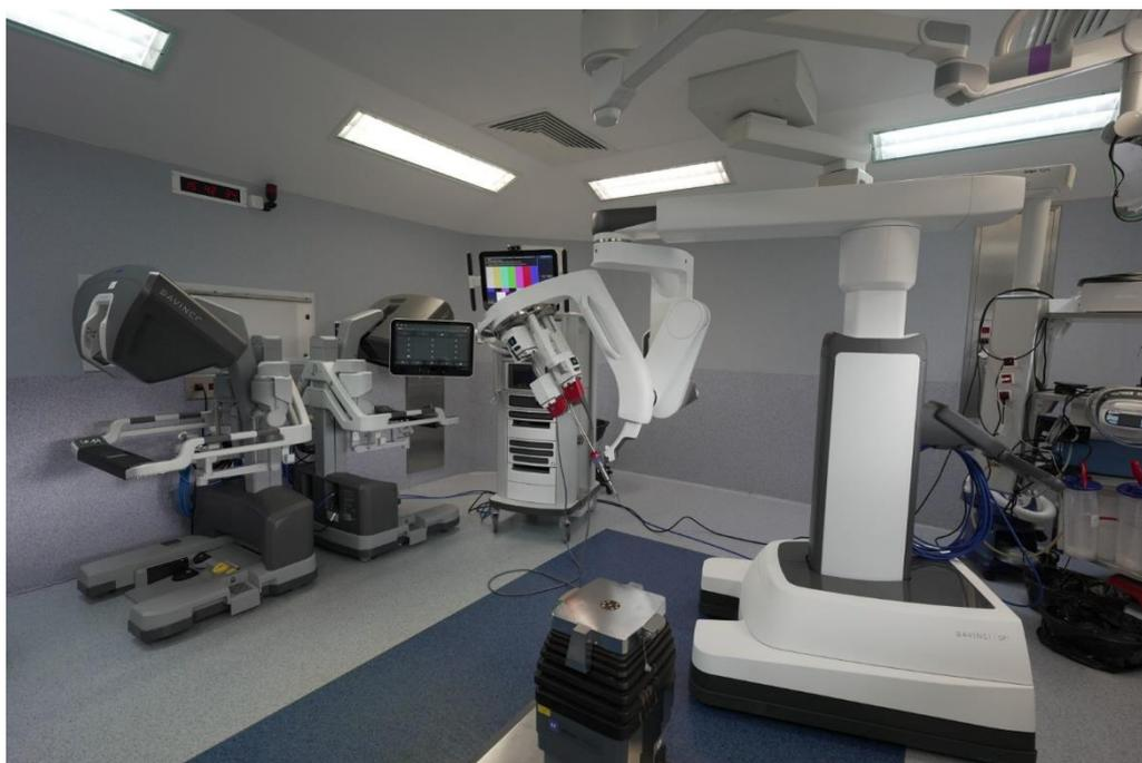
Arrivé à Gustave Roussy le 28 janvier 2025, le robot de chirurgie assistée da Vinci SP, développé par la société Intuitive Surgical, marque une nouvelle révolution dans le développement de la chirurgie robot-assistée à l'Institut. Équipé de trois bras robotiques et d'une caméra, il permet de réaliser des gestes chirurgicaux dans des zones anatomiques étroites et difficiles d'accès grâce à la miniaturisation des instruments (6 millimètres de diamètre).
